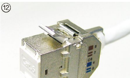
La connexion est terminée.
