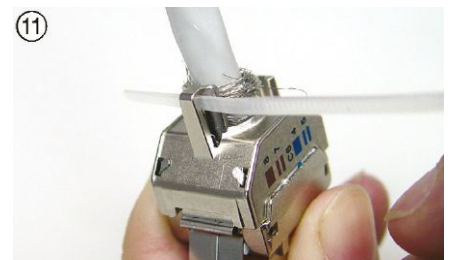
Insérer le collier dans l'ouverture et faire une boucle autour du câble sans l'écraser.
